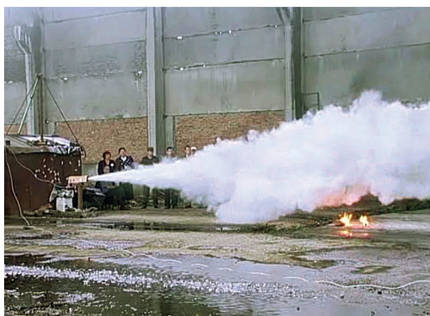
Распыл порошка при срабатывании МПП «Ураган-3», в горизонтальном направлении.
