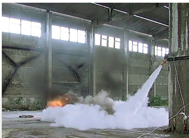
Распыл порошка при срабатывании МПП «Ураган-3», под углом наклона 30°
