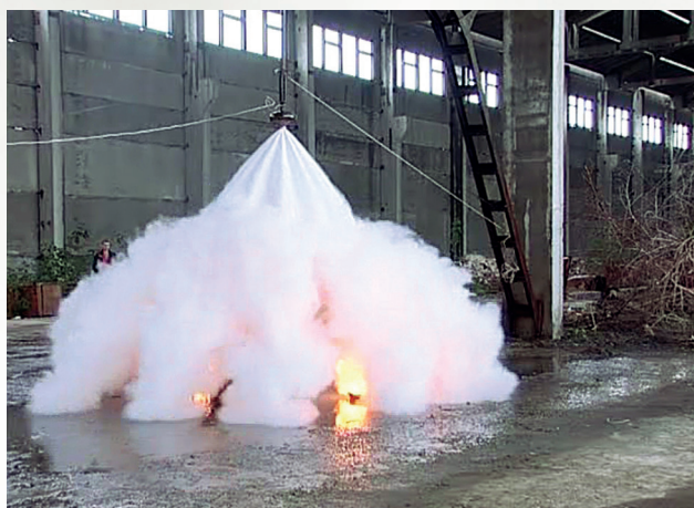
Распыл порошка при срабатывании МПП «Ураган-1М»
