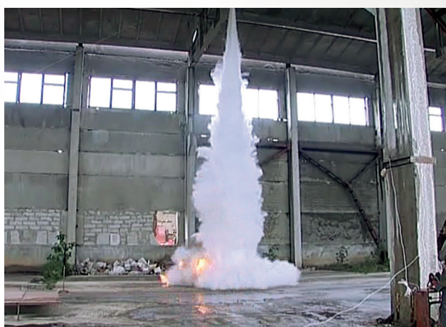
Распыл порошка при срабатывании МПП «Ураган-5М»
